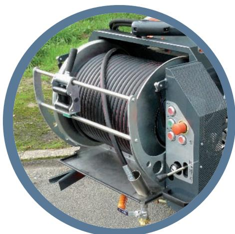
3. Segundo panel de control extraíble con bobina de AP, montada a una altura ergonómica de trabajo.
